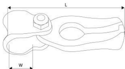
Gancio con occhiello per collegare rapidamente catene scorsoie lungo la fune di traino del verricello. Per funi fino a 16 mm di diametro.
