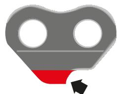
**Causa:** La catena ha oscillato nella scanalatura della barra. Taglienti non uniformi o guide della barra usurate
